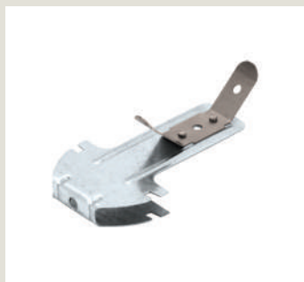
Подвес анкерный с зажимом Для КНАУФ-профилей ПП 60x27. Предназначен для крепления к перекрытию с помощью тяги подвеса.
