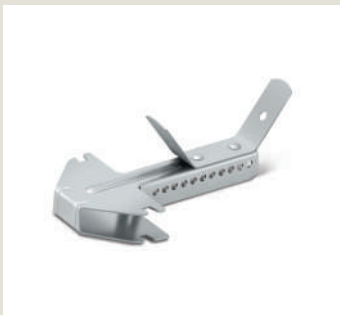
Подвес комбинированный Для КНАУФ-профилей ПП 60x27. Предназначен для крепления к перекрытию с помощью тяги подвеса или системы нониус-подвесов. Несущая способность с тягой-25 кН.
